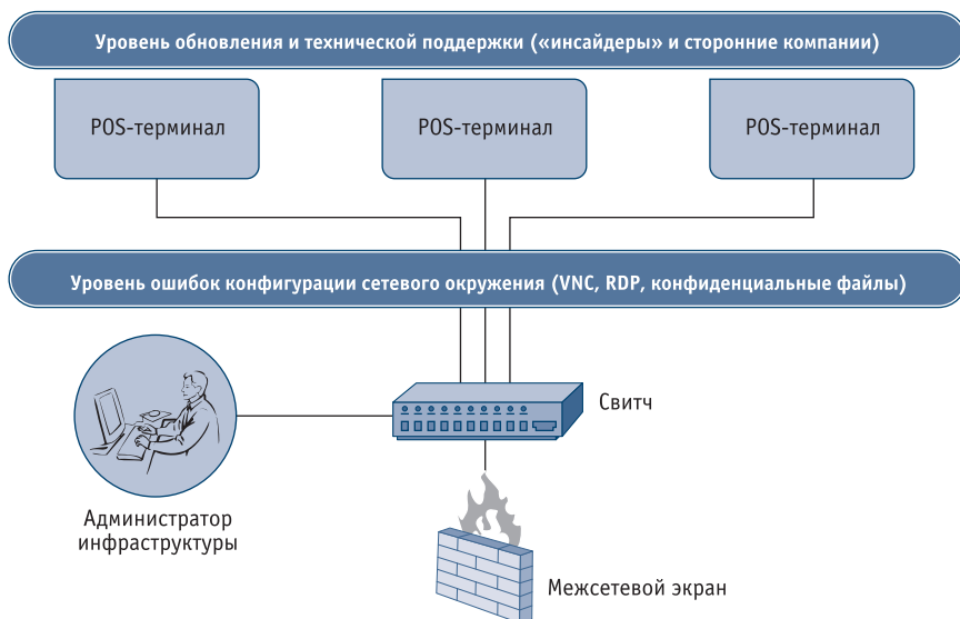
Рис. 4. Стандартная топология сетевой инфраструктуры торговой точки
